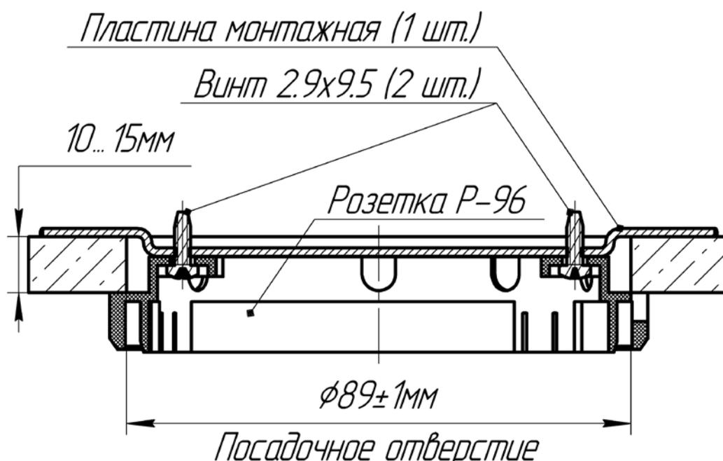
Рис. 1 - Установка розетки Р-96 в подвесном потолке.
